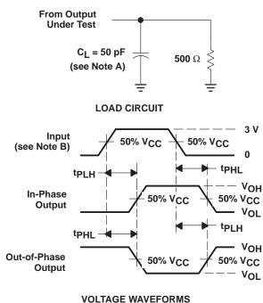
VOLTAGE WAVEFORMS PROPAGATION DELAY TIMES
