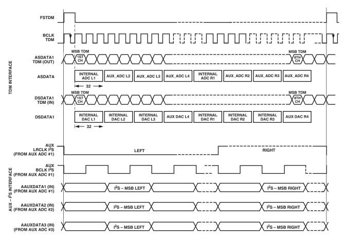
AUX BCLK FREQUENCY IS 64  $\times$  FRAME RATE; TDM BCLK FREQUENCY IS 256  $\times$  FRAME RATE.
