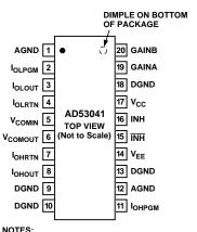
AGND IS THE HIGH-QUALITY GROUND REFERENCE FOR I<sub>OLFGM</sub> AND I<sub>OHPGM</sub>. DGND IS THE SUPPLY GROUND.
