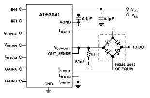
NOT SHOWN: THE AGND PINS ARE THE HIGH QUALITY GROUND REFERENCE FOR THE VOLTAGE-TO-CURRENT CONVERTERS. THE GND PINS PROVIDE RETURN PATHS FOR INTERNAL CURRENTS.  $V_{CC}$  IS THE POSITIVE SUPPLY,  $V_{EE}$  IS THE NEGATIVE SUPPLY. ALL GROUND PINS SHOULD BE CONNECTED TO THE SYSTEM ANALOG GROUND PLANE.
