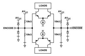
Figure 3. ENCODE Inputs
