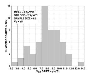
Figure 5. V<sub>OS</sub> Drift Over -40°C to +85°C
