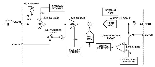
Figure 11. CCD-Mode Block Diagram
