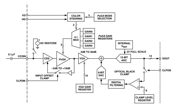
Figure 25. CCD-Mode Block Diagram
