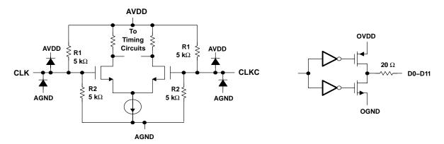
Figure 28. Clock Inputs
