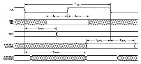
Figure 24. IEEE 11499.1 JTAG Test Access Port
