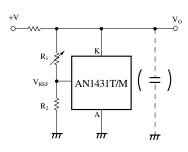
$$V_{\rm O} = \left(1 + \frac{R_1}{R_2}\right) V_{\rm REF}$$
