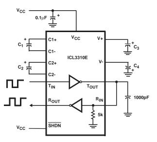
FIGURE 6. TRANSMITTER LOOPBACK TEST CIRCUIT
