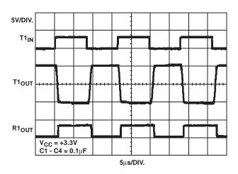
FIGURE 7. LOOPBACK TEST AT 120kbps
