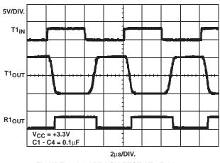
FIGURE 8. LOOPBACK TEST AT 250kbps
