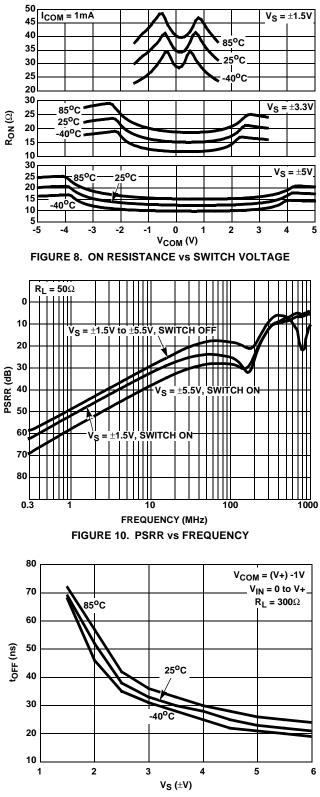
FIGURE 12. TURN - OFF TIME vs SUPPLY VOLTAGE
