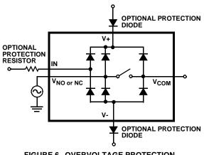
**FIGURE 6. OVERVOLTAGE PROTECTION**
