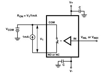
FIGURE 4. RON TEST CIRCUIT
