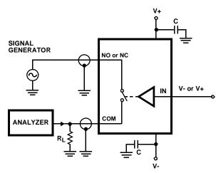
FIGURE 3. OFF ISOLATION TEST CIRCUIT
