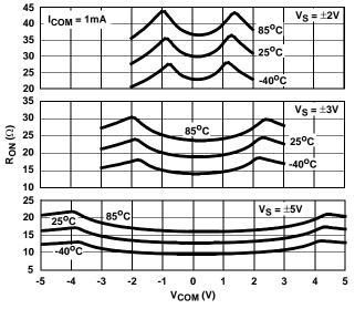
FIGURE 11. ON RESISTANCE vs SWITCH VOLTAGE
