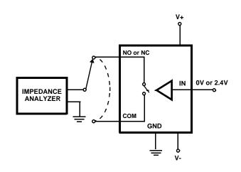
FIGURE 7. CAPACITANCE TEST CIRCUIT
