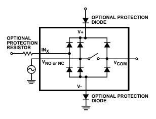
FIGURE 8. OVERVOLTAGE PROTECTION
