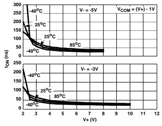
FIGURE 15. TURN - ON TIME vs POSITIVE SUPPLY VOLTAGE
