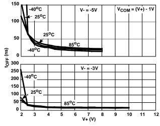
FIGURE 16. TURN - OFF TIME vs POSITIVE SUPPLY VOLTAGE
