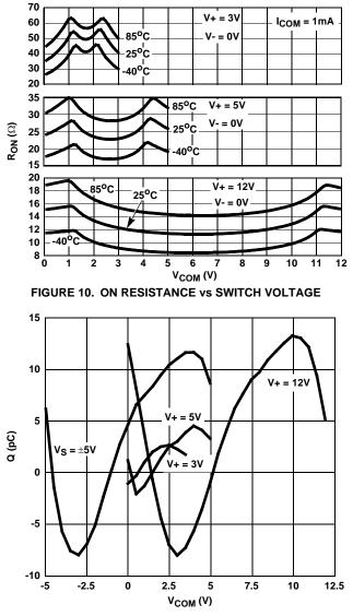
FIGURE 12. CHARGE INJECTION vs SWITCH VOLTAGE
