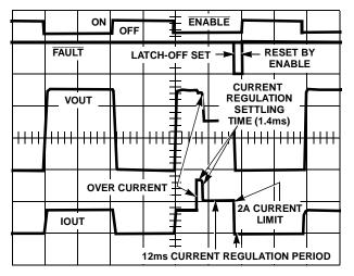
FIGURE 2. OPERATIONAL WAVEFORMS
