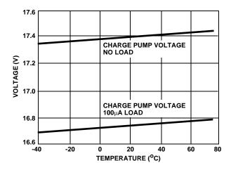
FIGURE 9. PUMP VOLTAGE
