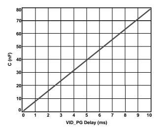
FIGURE 10. VID\_PG DELAY DEPENDENCE ON VID\_CT CAPACITOR
