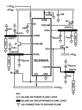
FIGURE 11. PRINTED CIRCUIT BOARD ISLANDS
