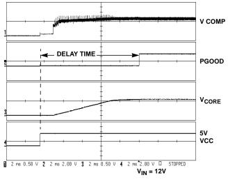
FIGURE 4. START-UP OF 4 PHASE SYSTEM OPERATING AT
