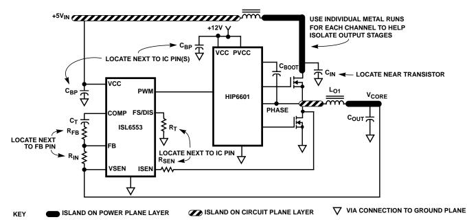
FIGURE 11. PRINTED CIRCUIT BOARD POWER PLANES AND ISLANDS
