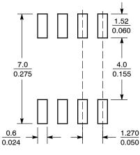
$\left(\frac{\text{mm}}{\text{inches}}\right)$ SCALE 6:1
