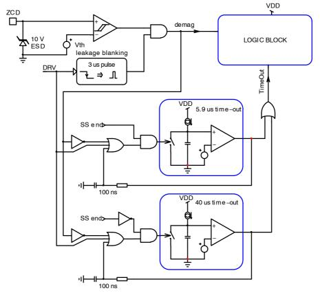
Figure 29. Time Out Circuit
