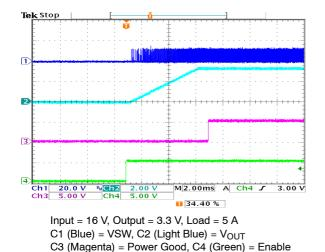
Figure 19. Soft-Start Waveforms
