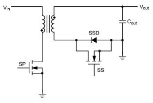
Figure 30. Synchronous Rectifier
