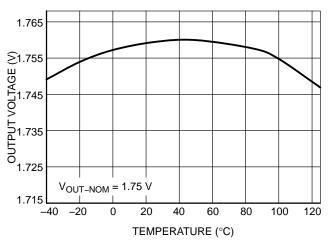
0.10  $V_{IN} = V_{OUT-NOM} + 0.5 V \text{ to } 5.0 V$ 0.08  $V_{IN} \ge 1.8 \text{ V}$ 0.06 0.04 0.02 0 0.02 0 0.02 0 0.02 0 0.03 0 0.04 0 0.02 -0.08V<sub>OUT-NOM</sub> = 1.75 V -0.10 -40 -20 20 40 60 80 100 120 TEMPERATURE (°C)
