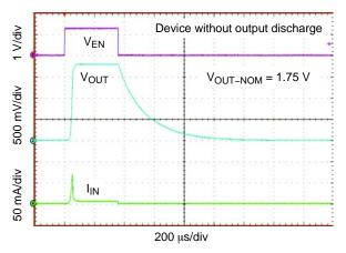
Figure 20. Turn-ON/OFF - EN Driven
