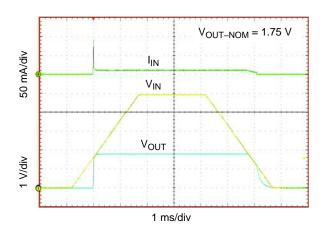
Figure 18. Turn-ON/OFF - V<sub>IN</sub> Driven (slow)
