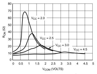
Figure 8. R<sub>ON</sub> vs. V<sub>COM</sub> and V<sub>CC</sub> (@25°C)
