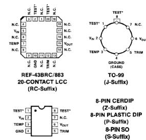
\*RESERVED FOR FACTORY TESTING. MAKE NO ELECTRICAL CONNECTION TO THESE PINS.
