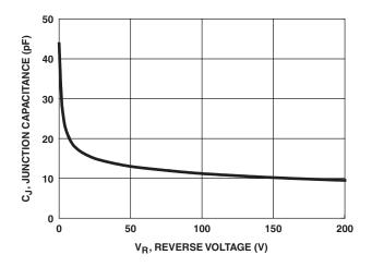
FIGURE 7. JUNCTION CAPACITANCE vs REVERSE VOLTAGE
