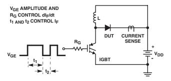
FIGURE 8. t<sub>rr</sub> TEST CIRCUIT
