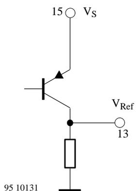
Figure 16. Pin 13  $V_{Ref}$
