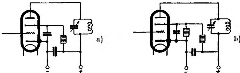
anordnung (Bild b) erfolgen muß, deren Eigenstromverbrauch groß ist gegenüber dem Schirmgitterstrom. Um Dämpfungen des Gitterkreises durch Gitterstrom zu vermeiden, empfiehlt es sich, dem Steuergitter eine negative Gittervorspannung zu erteilen.
